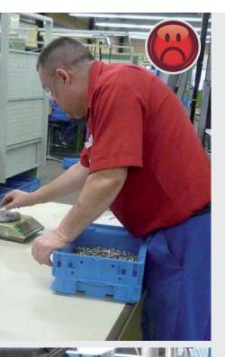
Die Umpositionierung der Waage sorgt für eine aufrechte Körperhaltung.
